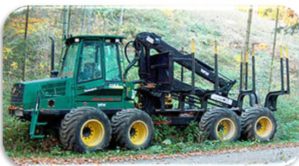
Abatteuse avec porteur © Wikipédia
